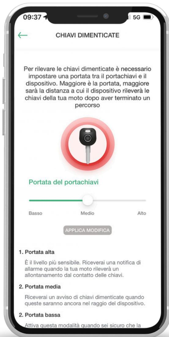
È possibile modificare la distanza da cui si potrà stabilire che si sono dimenticate le chiavi sulla moto.
